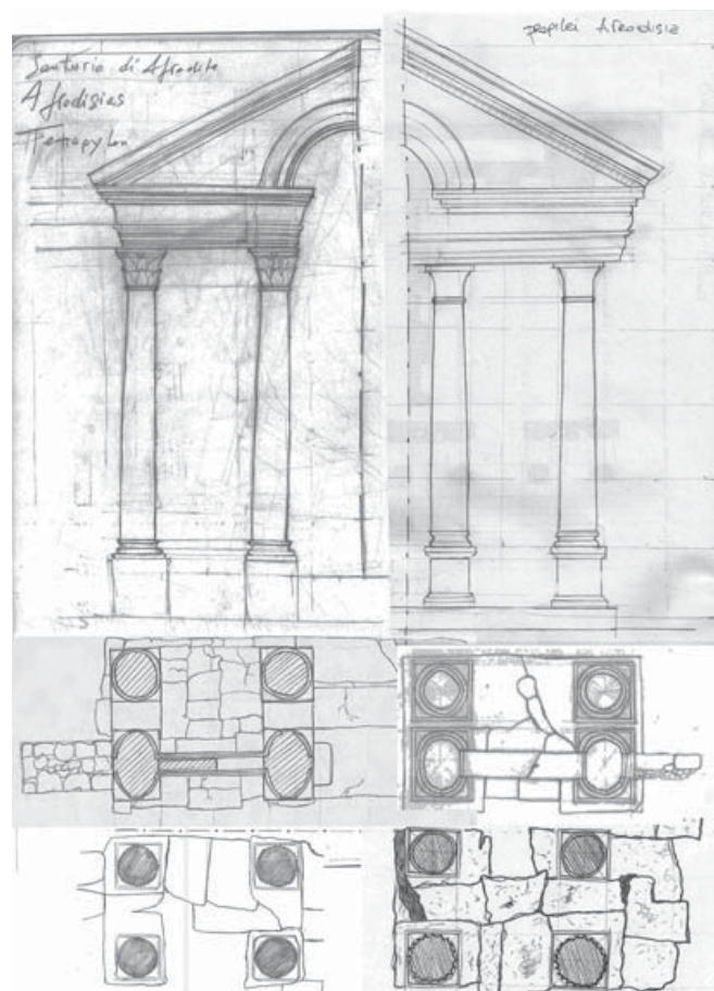
Figura 8. Anastilosi grafica per la ricostruzione della pianta e del prospetto del Propileo del Sebasteion in Aphrodisias attraverso i disegni realizzati da Lollino Walter, Dattoli Rossella, Di Giorgio Gaetana, Sgaramella Giancarlo, Corona Marta., studenti del Politecnico di Bari
