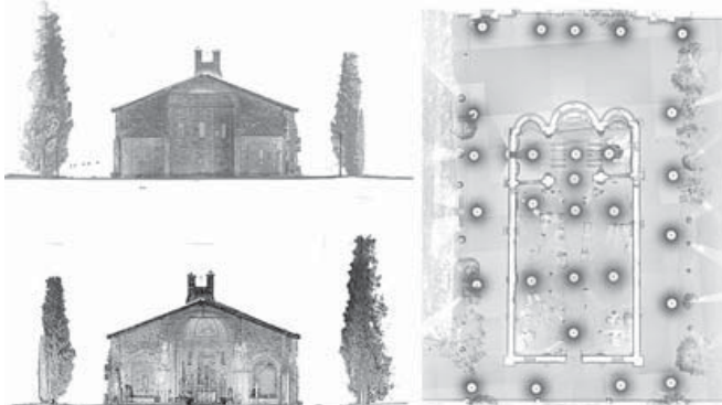
Figura 8. Dal rilievo 3D laser scanning alla produzione di proiezioni ortografiche.
